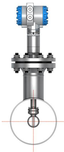
Рисунок 3.21 – Монтаж зондового расходомера
